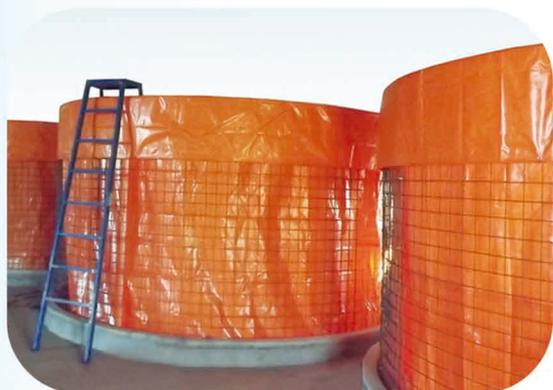
O Silo de Tela e Lona proporciona um custo reduzido para o armazenamento de grãos e farelados, substituindo o uso de sacarias. Utilizado para manter a qualidade dos grãos armazenados, evitando a sua deterioração. Sua principal vantagem é a fácil montagem e a manutenção reduzida, com um custo extremamente menor.
